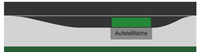
Abb. 3: Die Busbucht befindet sich wie eine zusätzliche Fahrspur rechts neben der Fahrbahn und galt in der Vergangenheit (zu Zeiten noch geringeren Straßenverkehrs) häufig als Regelfall einer Haltestelle.
