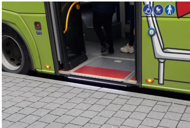
Abb. 22: Durch nahes Anfahren und Kneeling-Funktion des Busses kann die Reststufe und Spaltbreite zwischen Fahrzeugboden und Bussteigkante deutlich reduziert werden – im Idealfall auf 5 x 5 cm.
