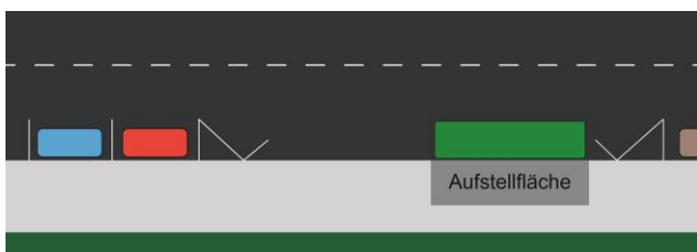
Abb. 2: Haltestelle am Fahrbahnrand mit Längsparkstreifen
